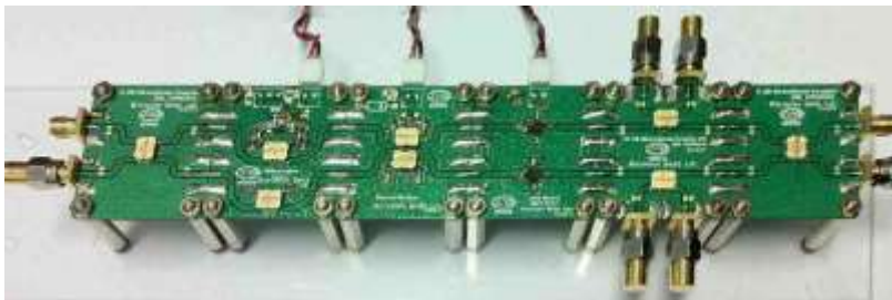
그림 2-4 검증용 UHF 대역 MPA 블록
